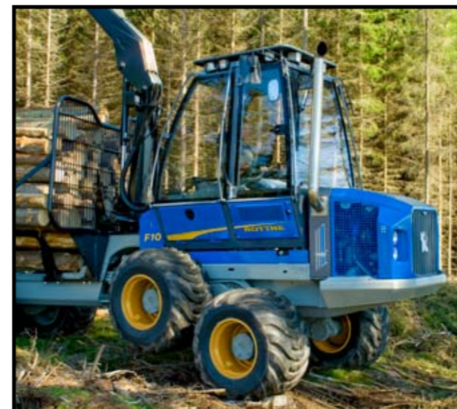
Grosser Bogieausschlag bedeutet gute Stabilität. Tandemachsanehebung als Sonderausrüstung.
